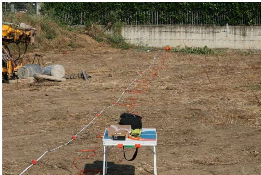
Foto: esecuzione della prospezione sismica MASW
