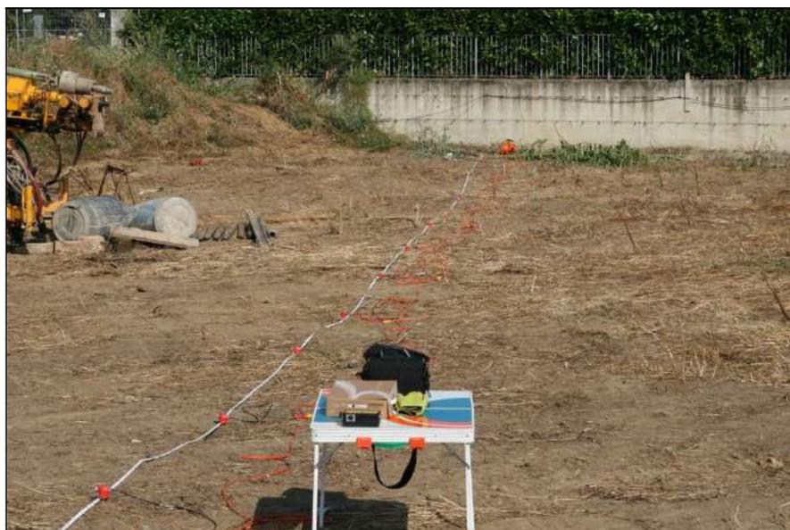
Foto: esecuzione della prospezione sismica MASW
