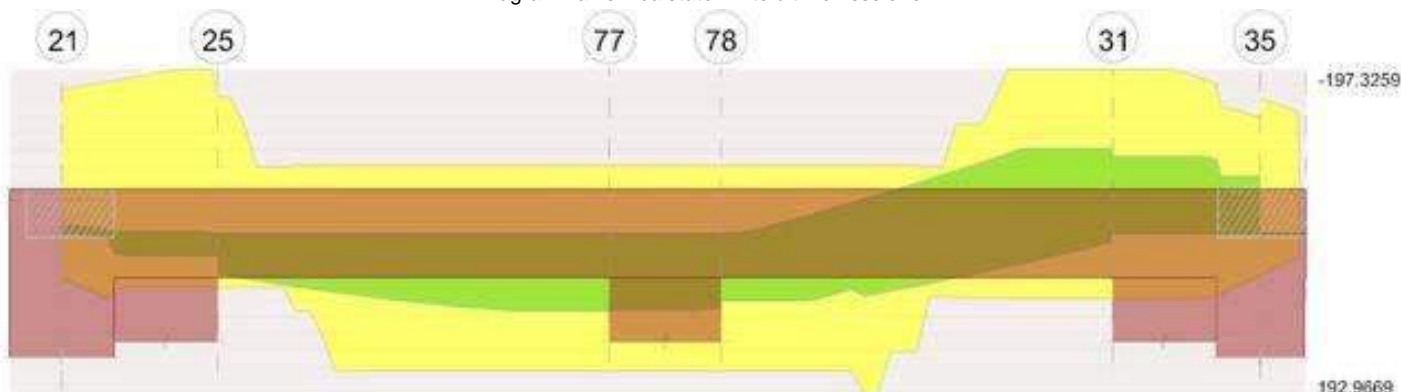
Diagramma verifica stato limite ultimo taglio
