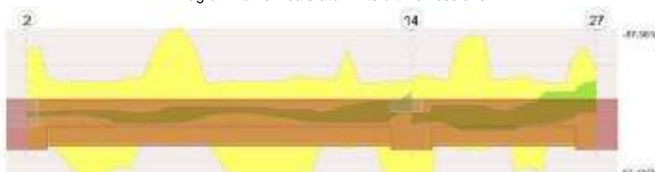
Diagramma verifica stato limite ultimo taglio
