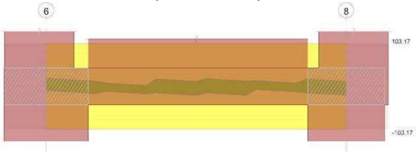
Diagramma verifica stato limite ultimo taglio
