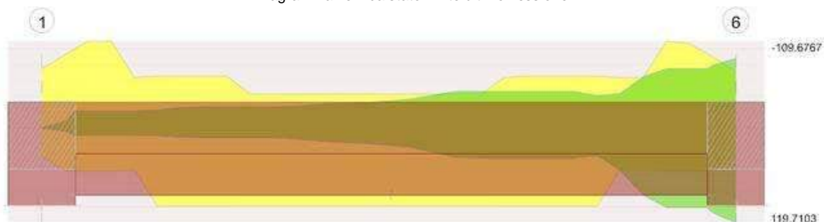
Diagramma verifica stato limite ultimo taglio
