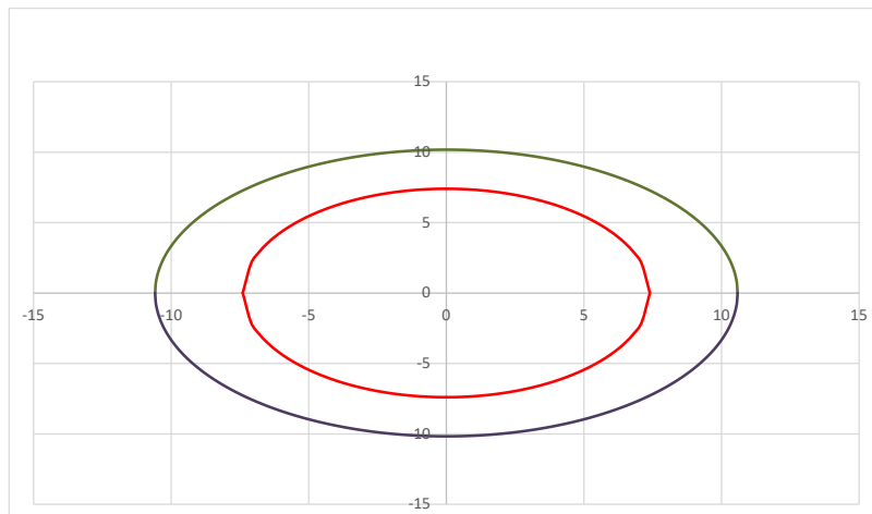
Figura 6 – Ellisse delle masse (rosso) e delle rigidezze ( Verde)
