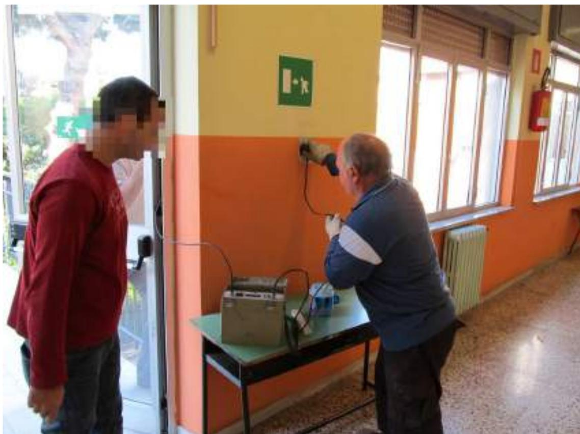
**Figura 83** - Ultrasuoni pilastro P/1P/16
