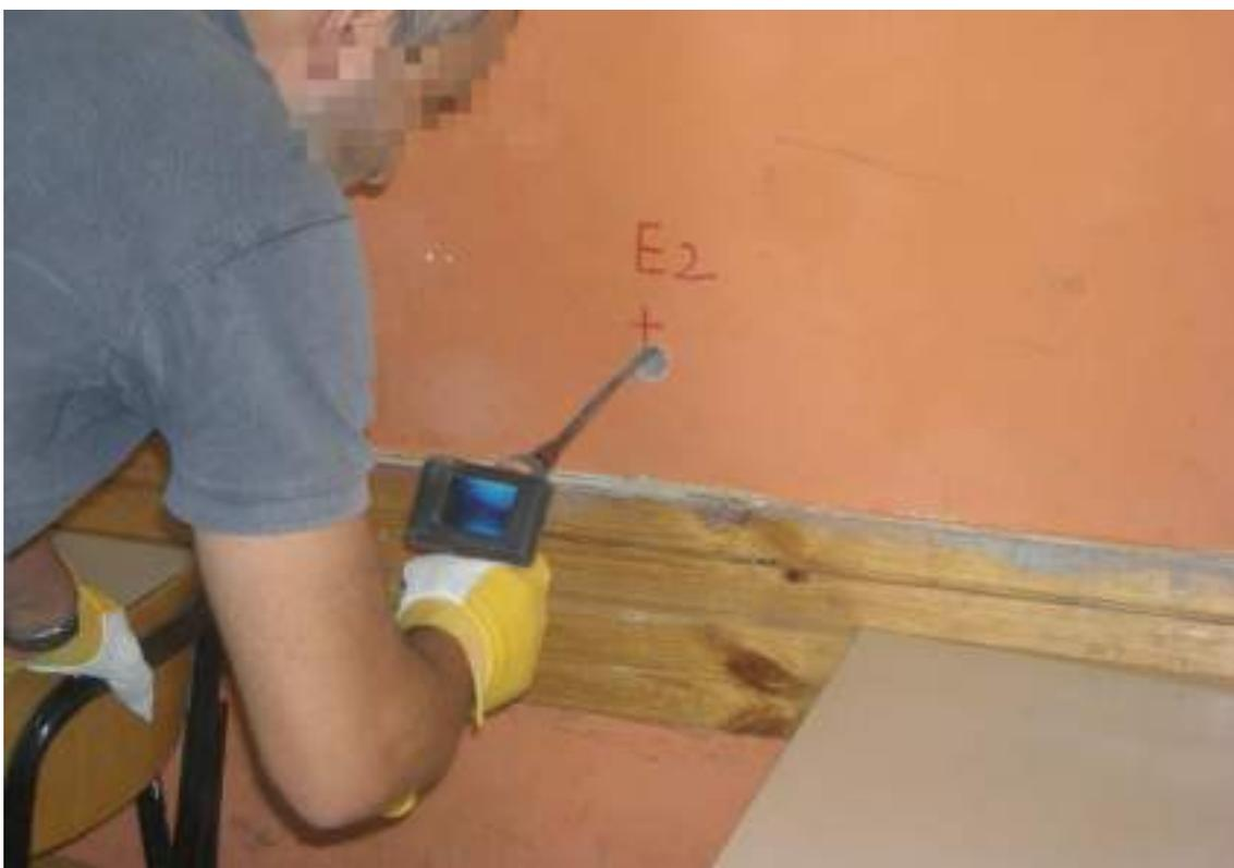
**Figura 2** – Indagine endoscopica muratura (E2, Corpo A).
