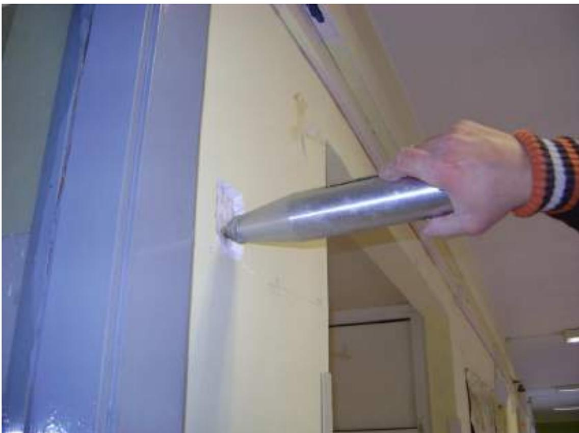
**Figura 74** - Sclerometria pilastro P/1P/11
