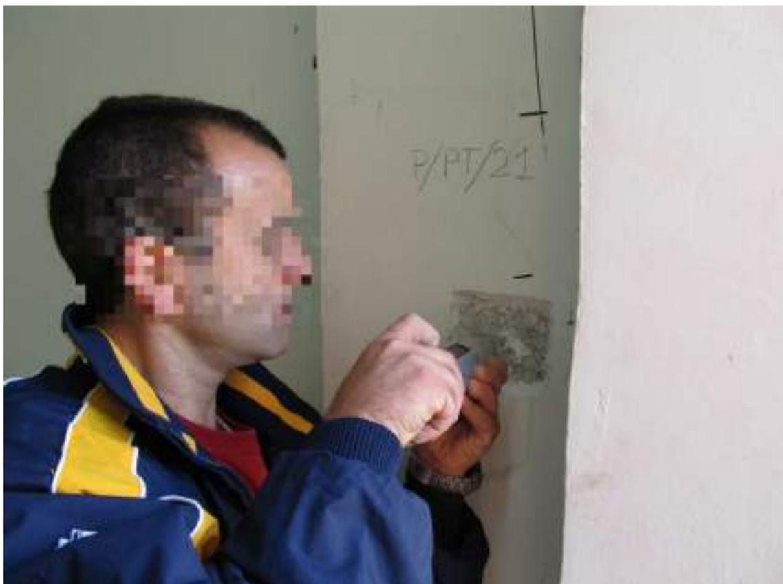
**Figura 68** - Sclerometria pilastro P/PT/21
