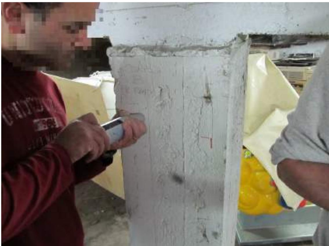
**Figura 84** - Sclerometria pilastro centrale Corpo B - PS
