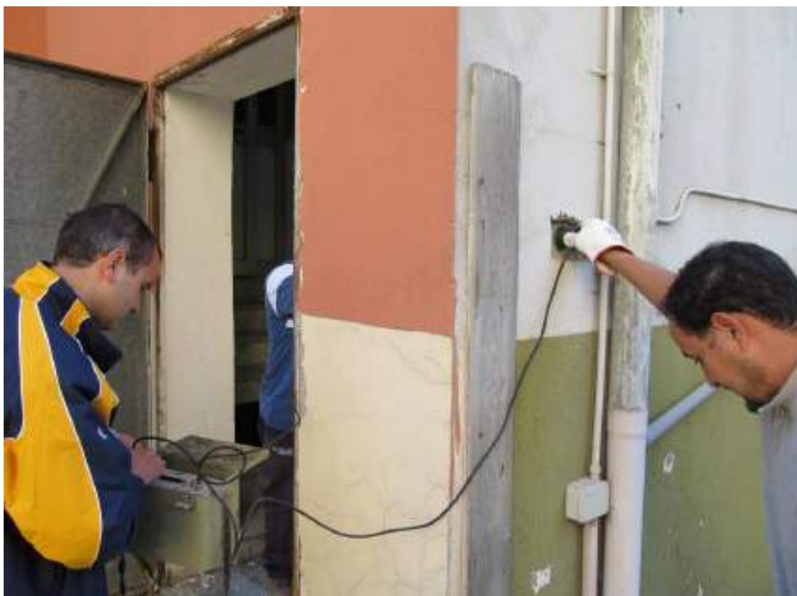
**Figura 69** - Ultrasuoni pilastro P/PT/21
