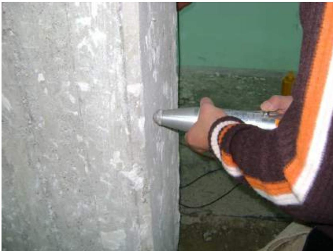
**Figura 44** - Sclerometria pilastro P/PS/11
