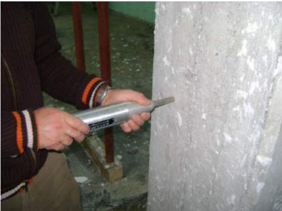
**Figura 48** - Sclerometria pilastro P/PS/9
