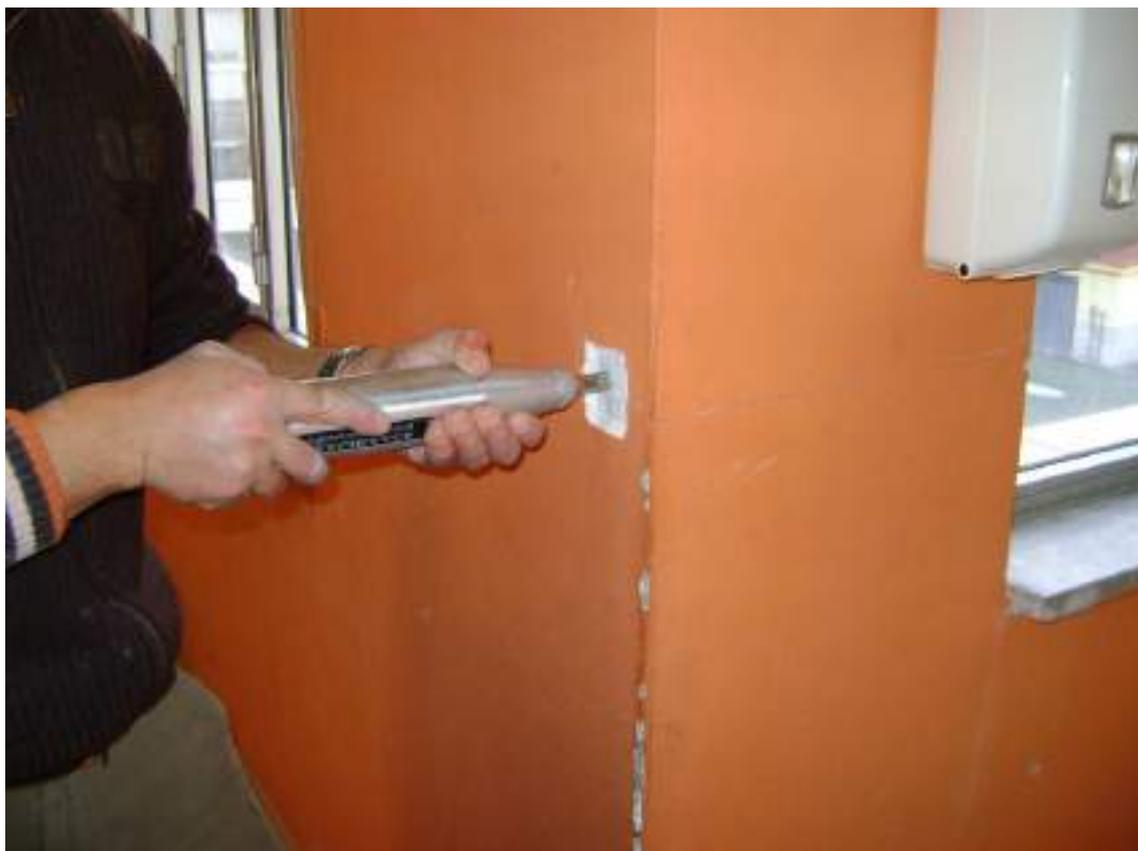
**Figura 76** - Sclerometria pilastro P/1P/14
