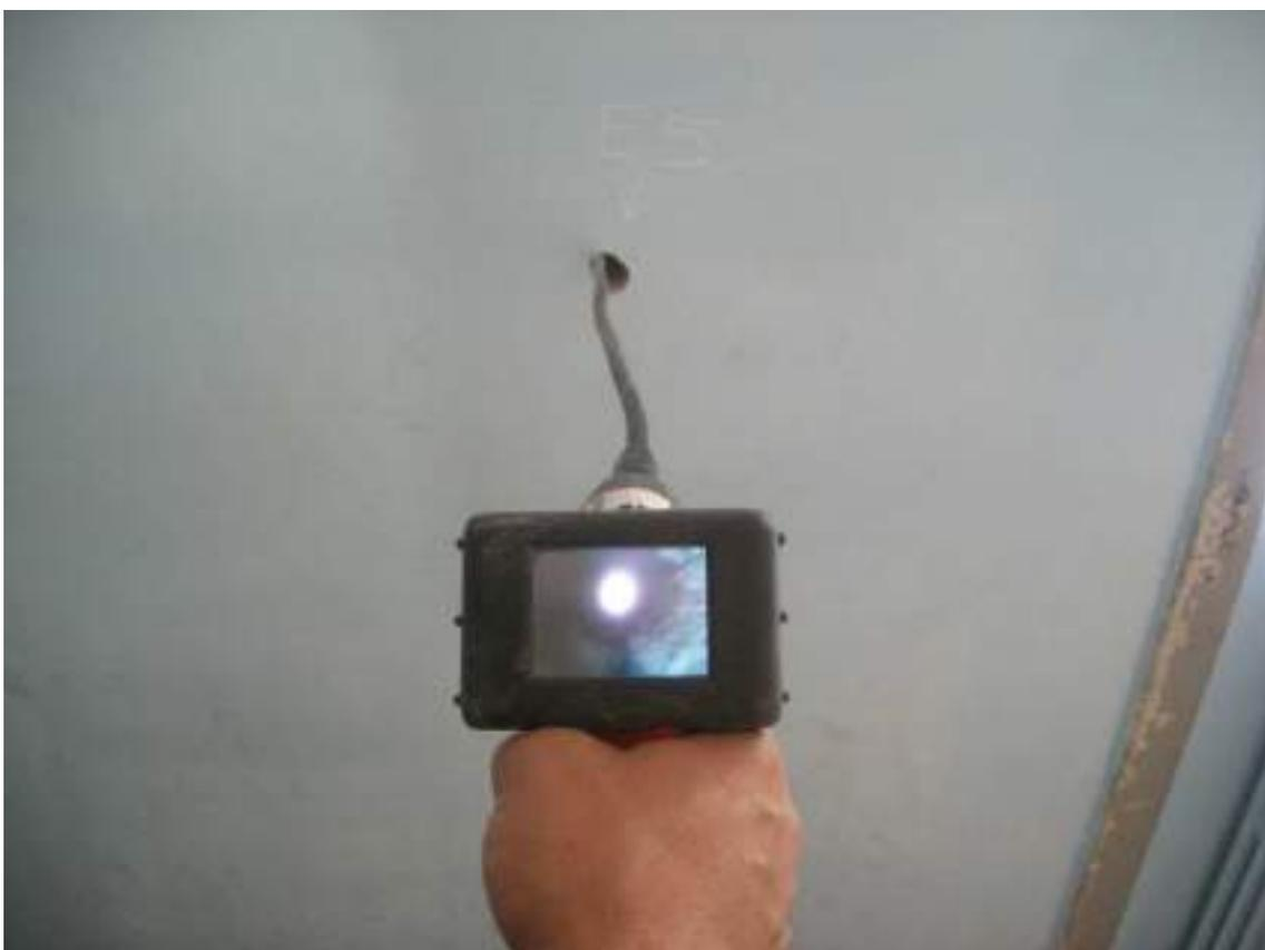
**Figura 8** – Indagine endoscopica muratura (E5, Corpo B).
