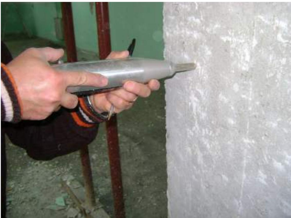
**Figura 46** - Sclerometria pilastro P/PS/10
