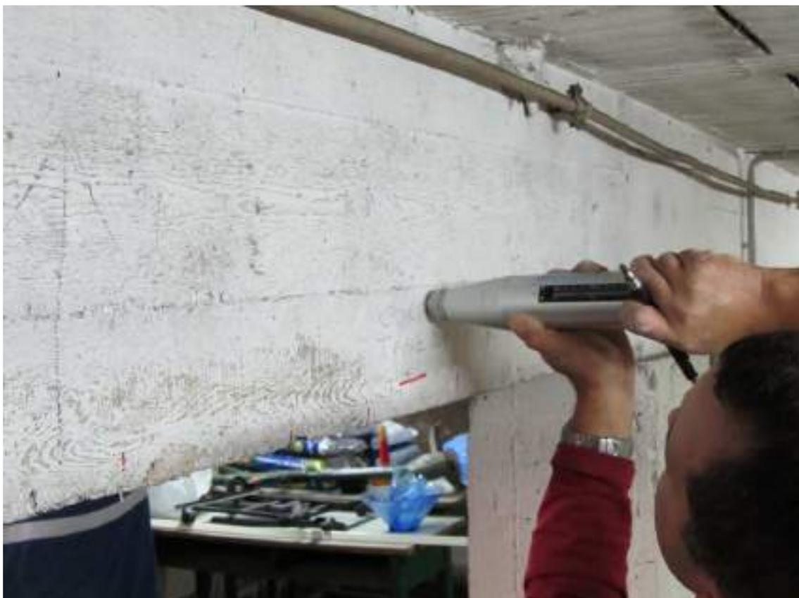
**Figura 88** - Sclerometria trave dx Corpo B - PS
