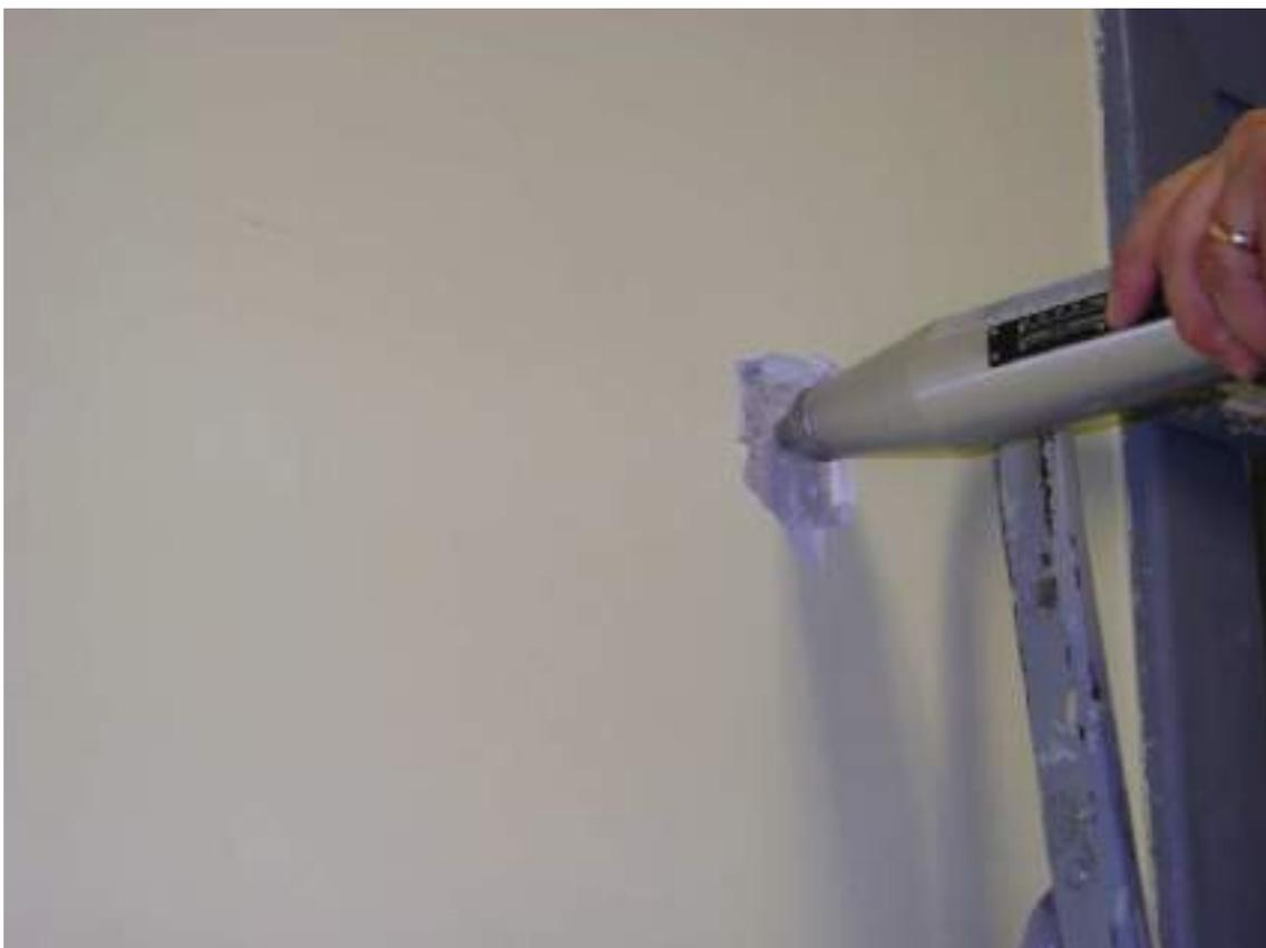
**Figura 72** – Sclerometria pilastro P/1P/8
