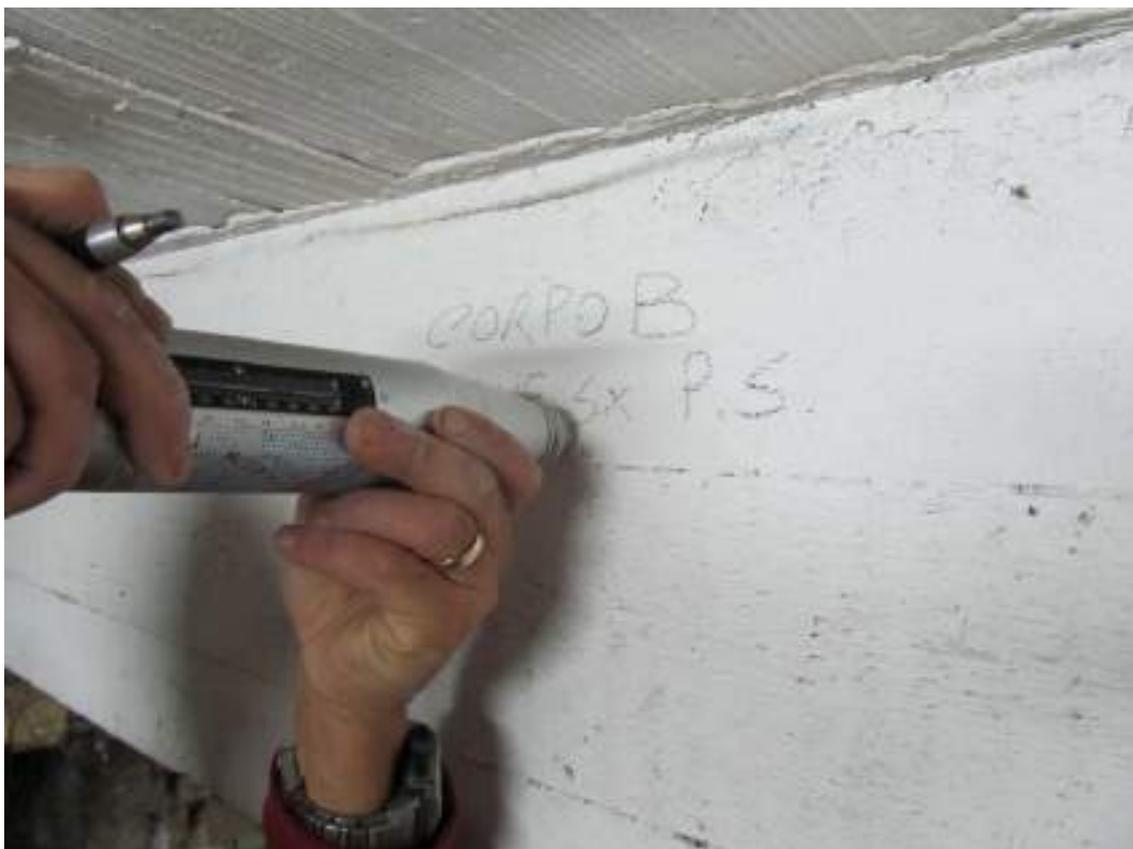
**Figura 86** - Sclerometria trave sx Corpo B - PS
