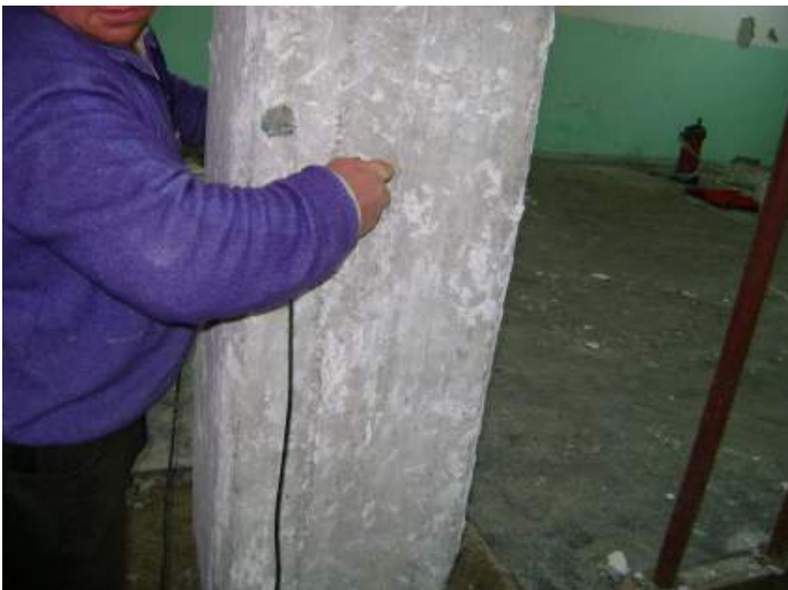
**Figura 49** - Ultrasuoni pilastro P/PS/9
