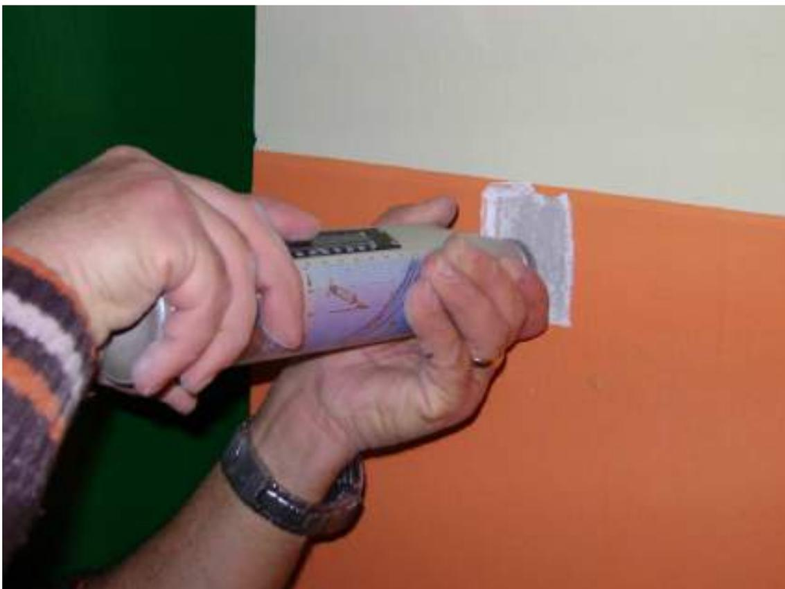
**Figura 80** - Sclerometria pilastro P/1P/23
