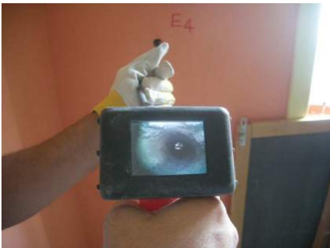
**Figura 4** – Indagine endoscopica muratura (E4, Corpo A).
