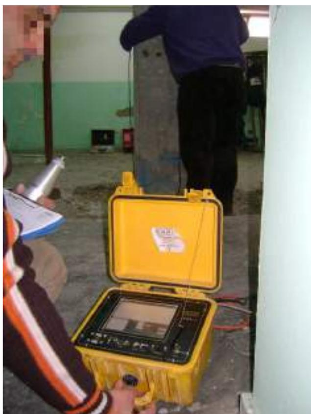
**Figura 45** - Ultrasuoni pilastro P/PS/11
