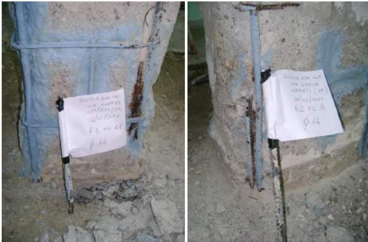
**Figure 13 e 14** – Prelievo barra acciaio (F1= Ø14; F2=Ø14).
