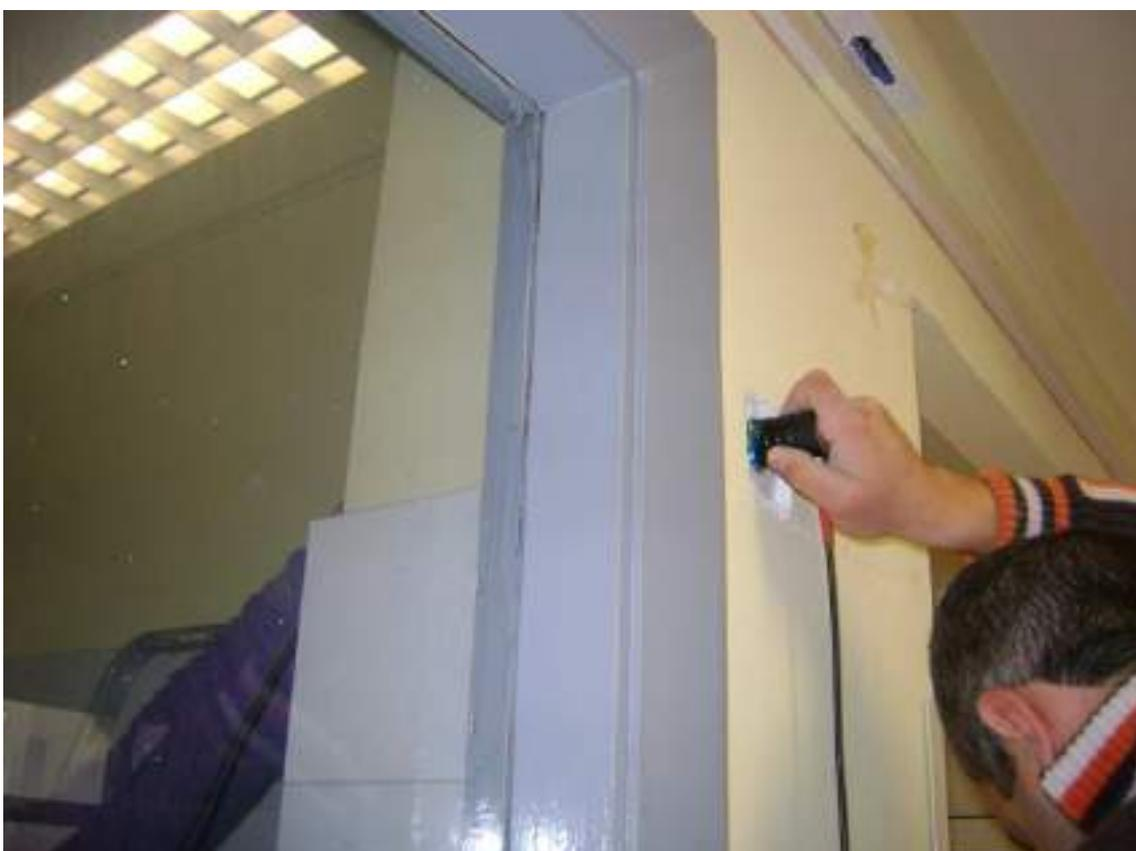
**Figura 75** - Ultrasuoni pilastro P/1P/11
