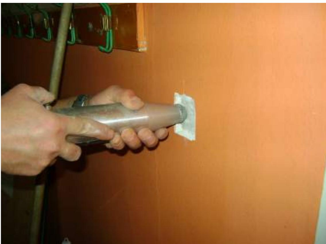
**Figura 59** – Sclerometria pilastro P/PT/9
