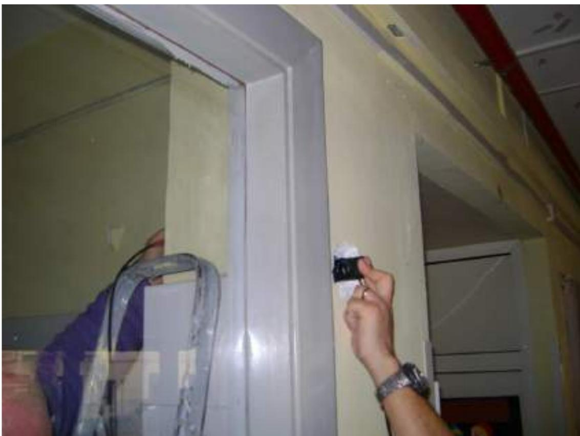
**Figura 67** – Ultrasuoni pilastro P/PT/11
