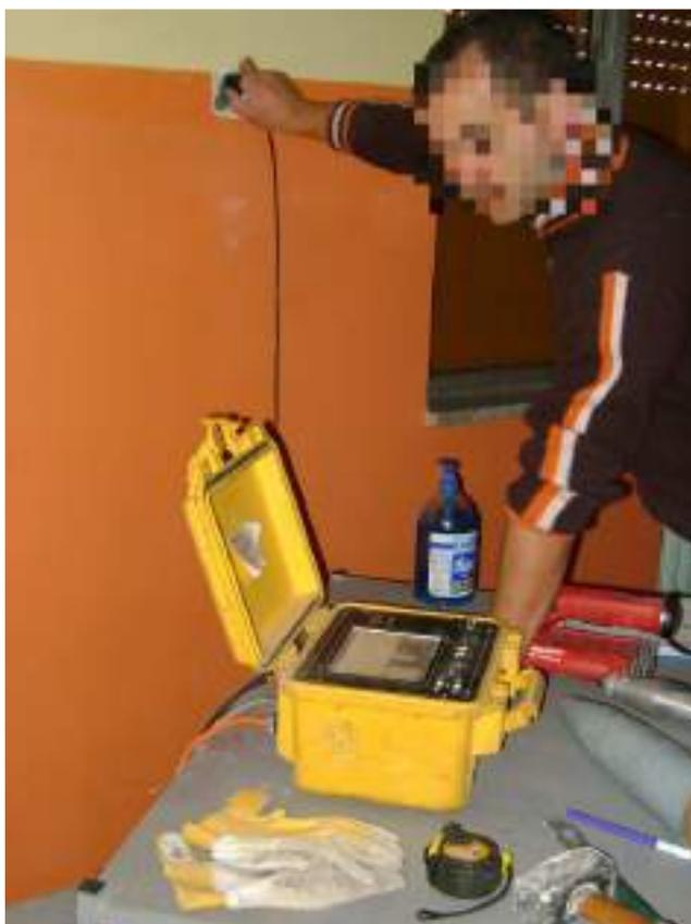
**Figura 61** - Ultrasuoni pilastro P/PT/16
