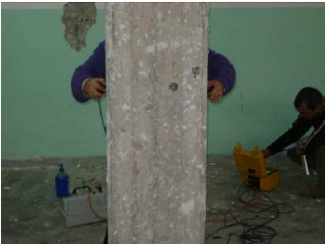
**Figura 50** - Ultrasuoni pilastro P/PS/8
