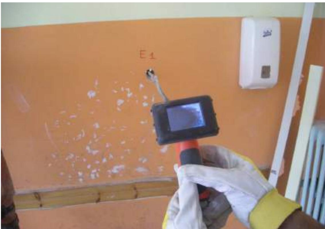
**Figura 1** – Indagine endoscopica muratura (E1, Corpo A).
