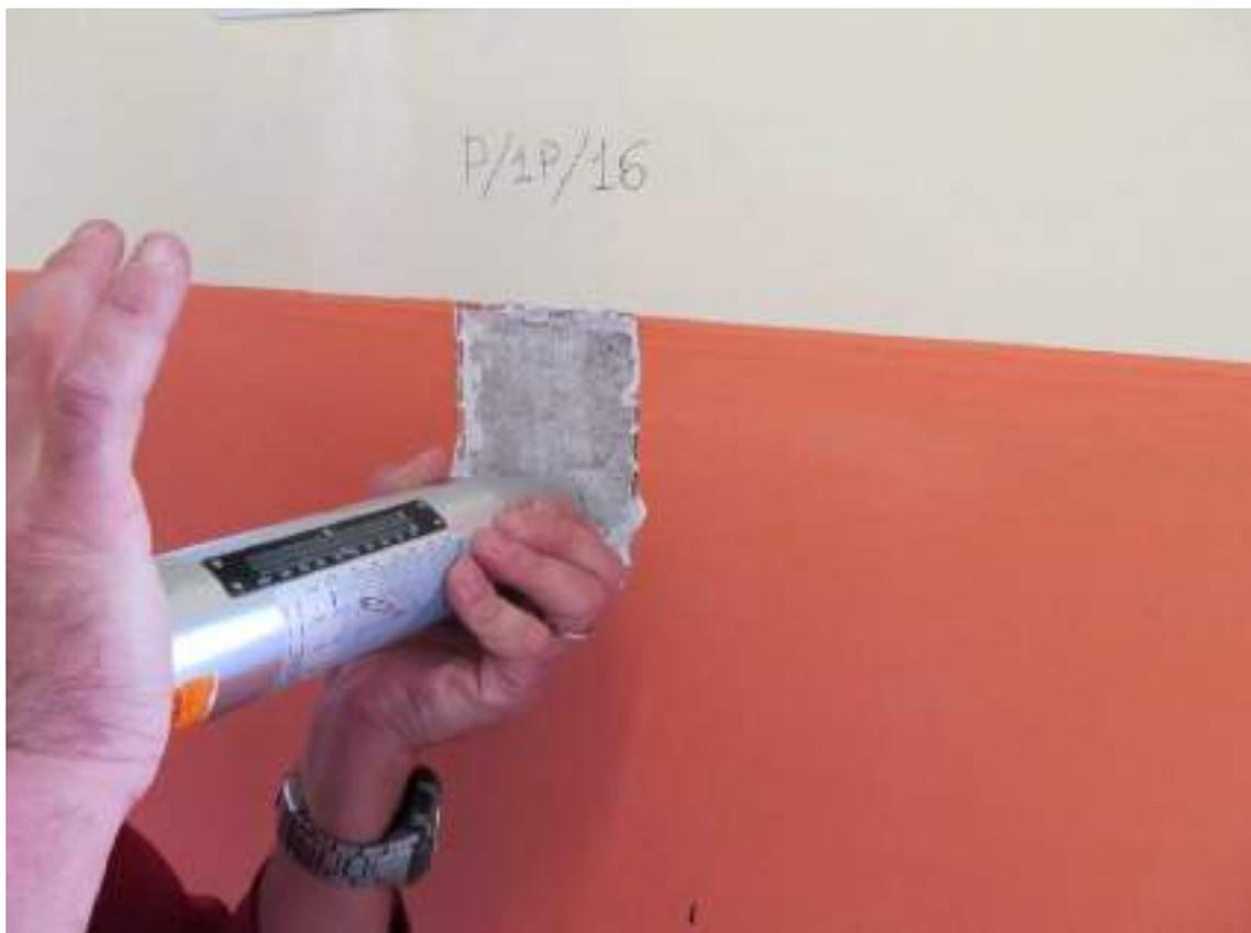
**Figura 82** - Sclerometria pilastro P/1P/16
