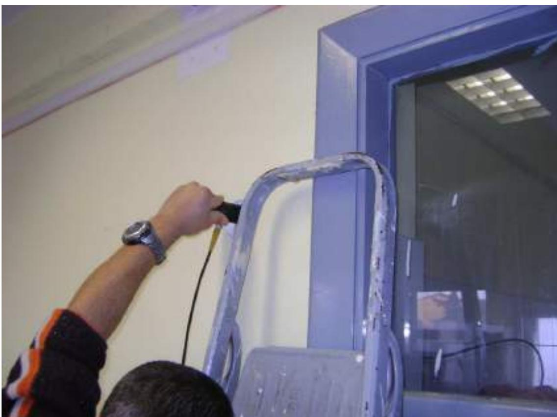
**Figura 73** - Ultrasuoni pilastro P/1P/8
