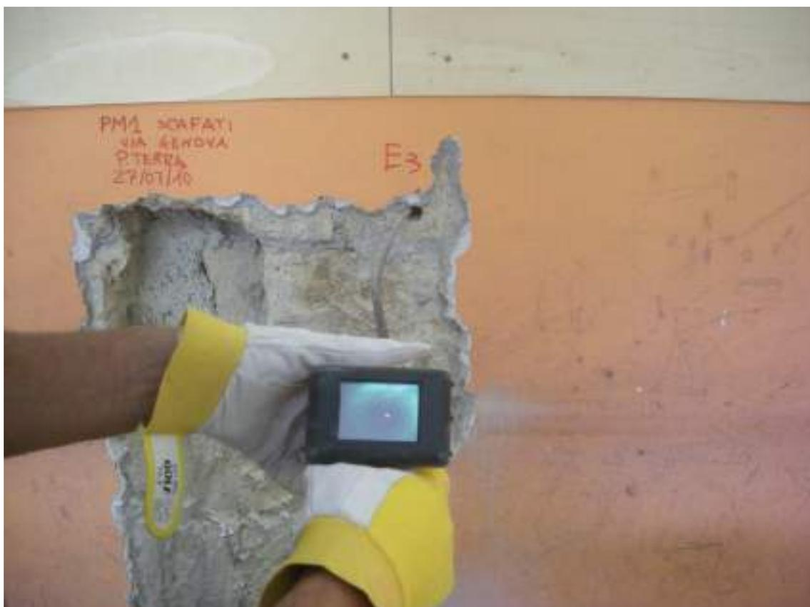
**Figura 3** – Indagine endoscopica muratura (E3, Corpo A).
