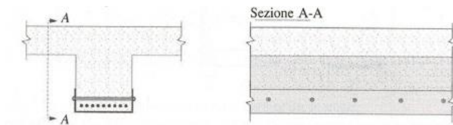
Figura 3: Esempio di placcaggio con lamina in acciaio
