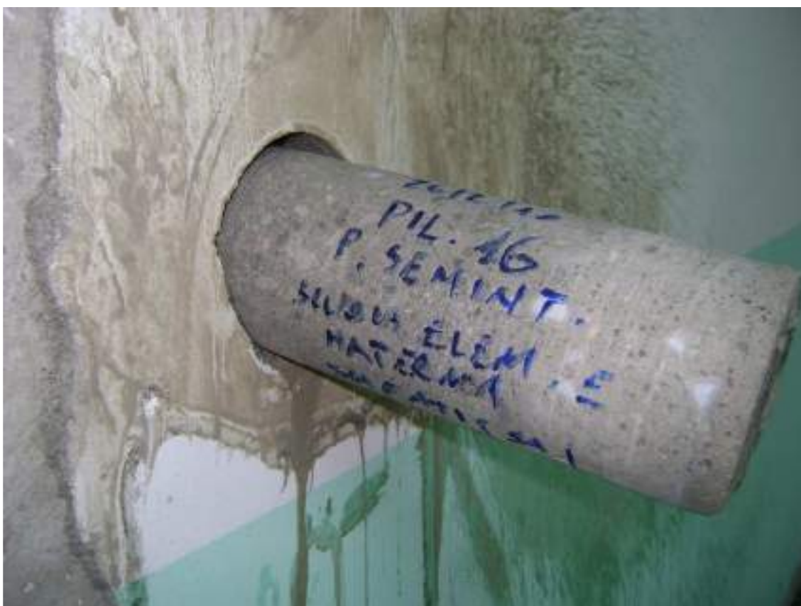
Figura 33 - Prelievo carota C2
