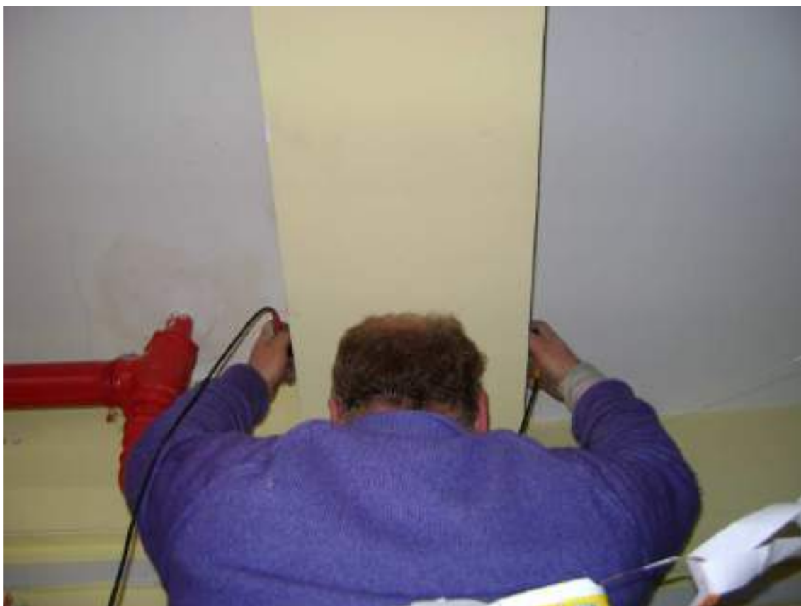
Figura 65 - Ultrasuoni trave T/PT/7-18
