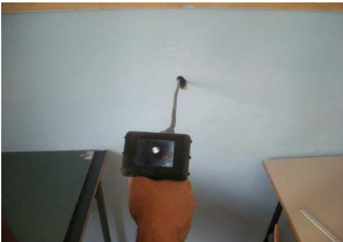
Figura 9 - – Indagine endoscopica muratura (E6, Corpo B).
