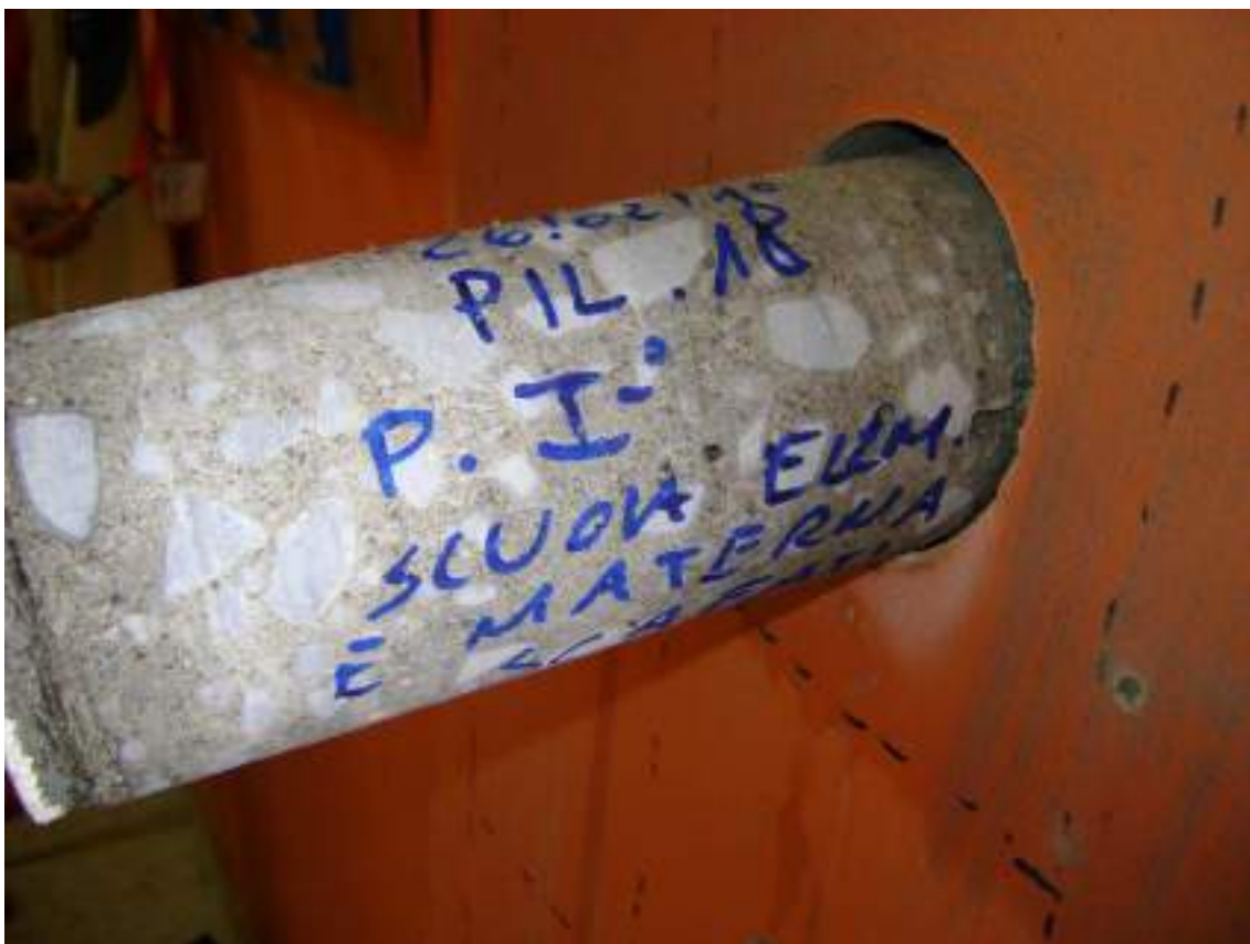
Figura 38 - Prelievo carota C5
