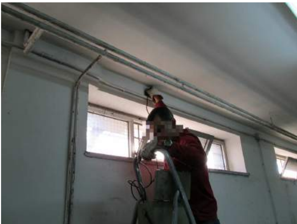
Figura 57 - Ultrasuoni trave T/PS/4-5
