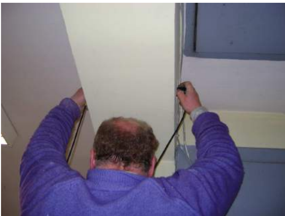
Figura 79 - Ultrasuoni trave T/1P/13-14
