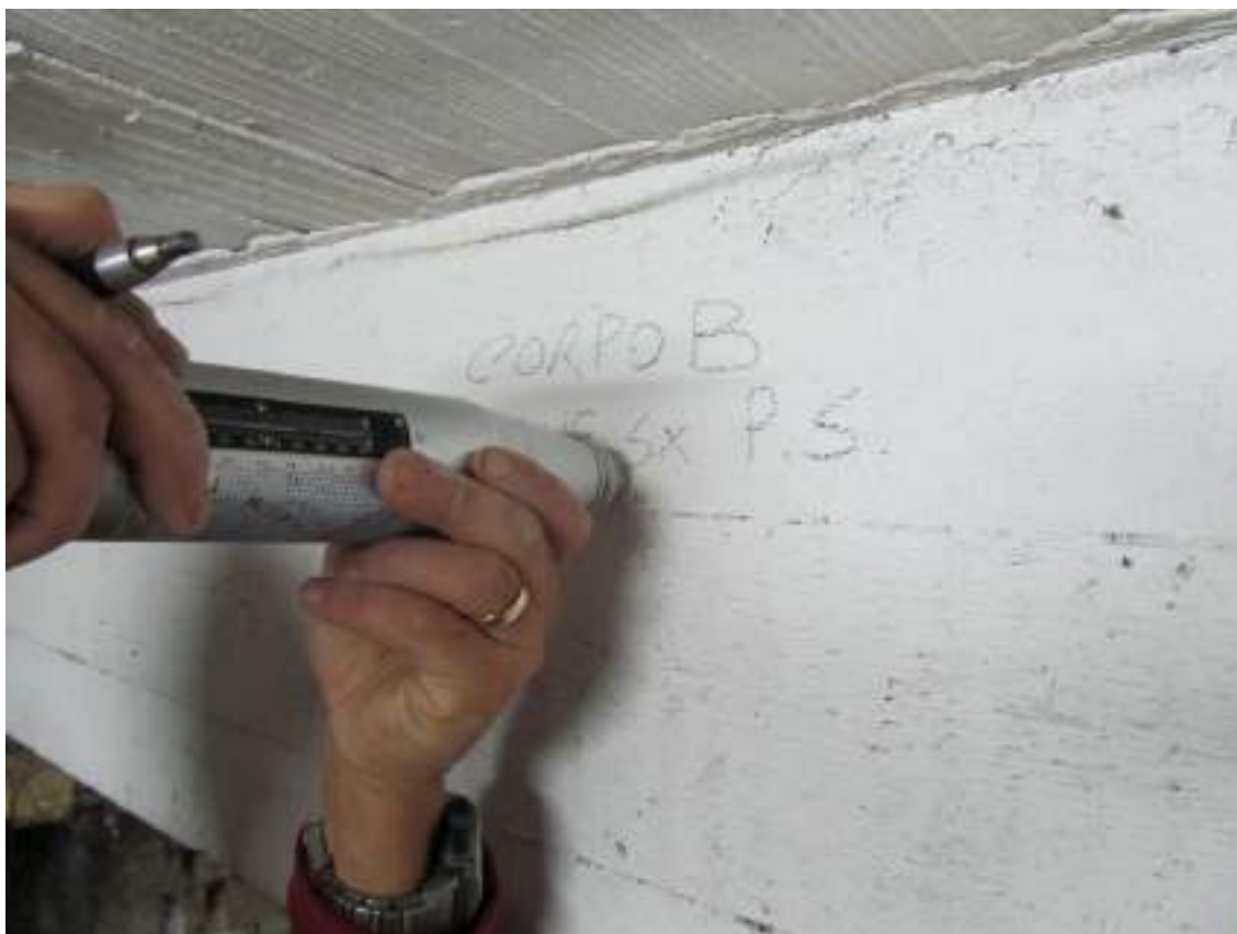
Figura 86 - Sclerometria trave sx Corpo B - PS
