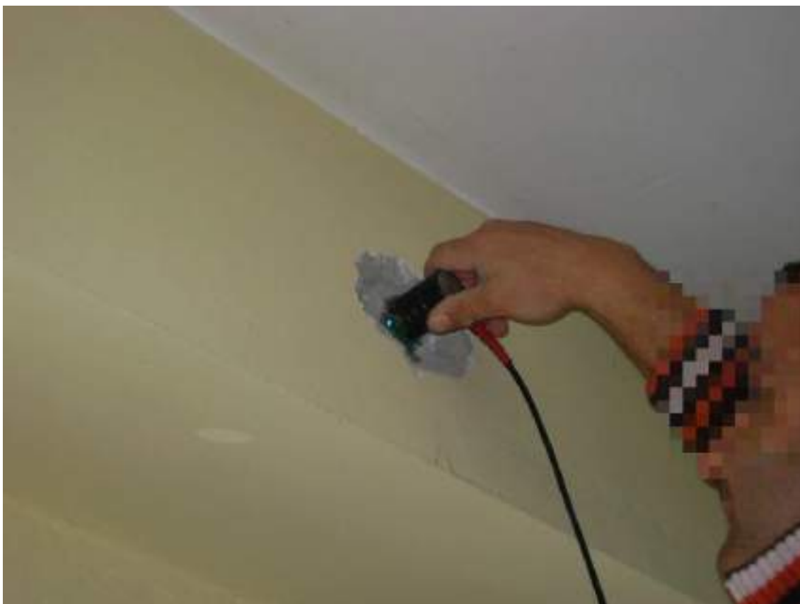
Figura 58 – Ultrasuoni trave T/PT/16-17
