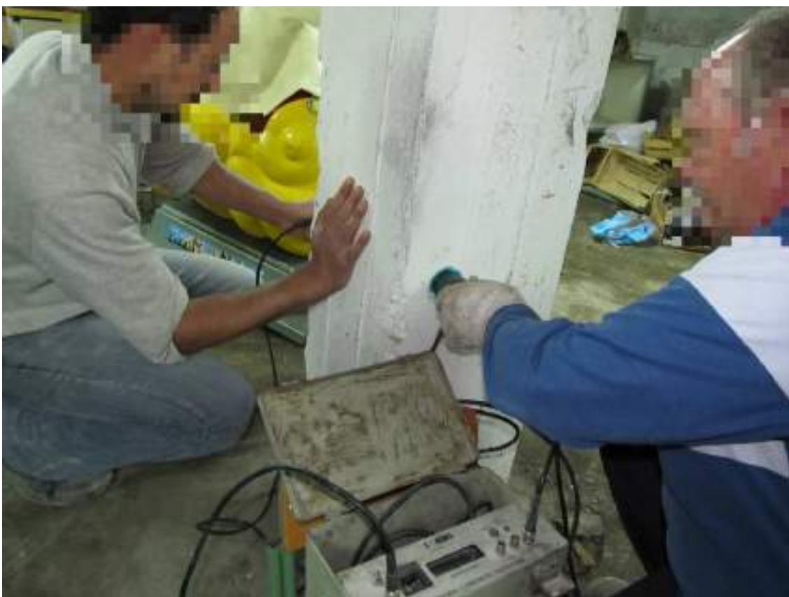
Figura 85 - Ultrasuoni pilastro centrale Corpo B - PS
