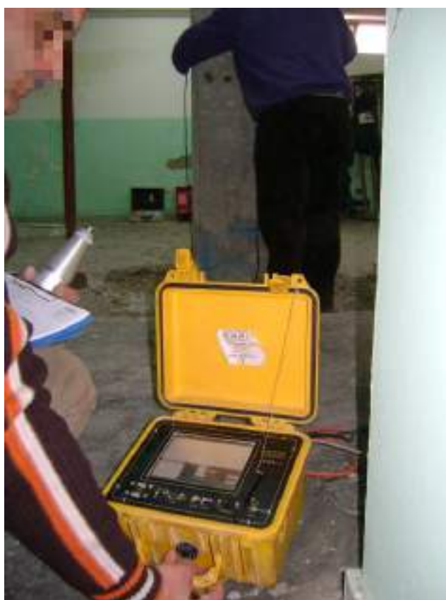
Figura 45 - Ultrasuoni pilastro P/PS/11
