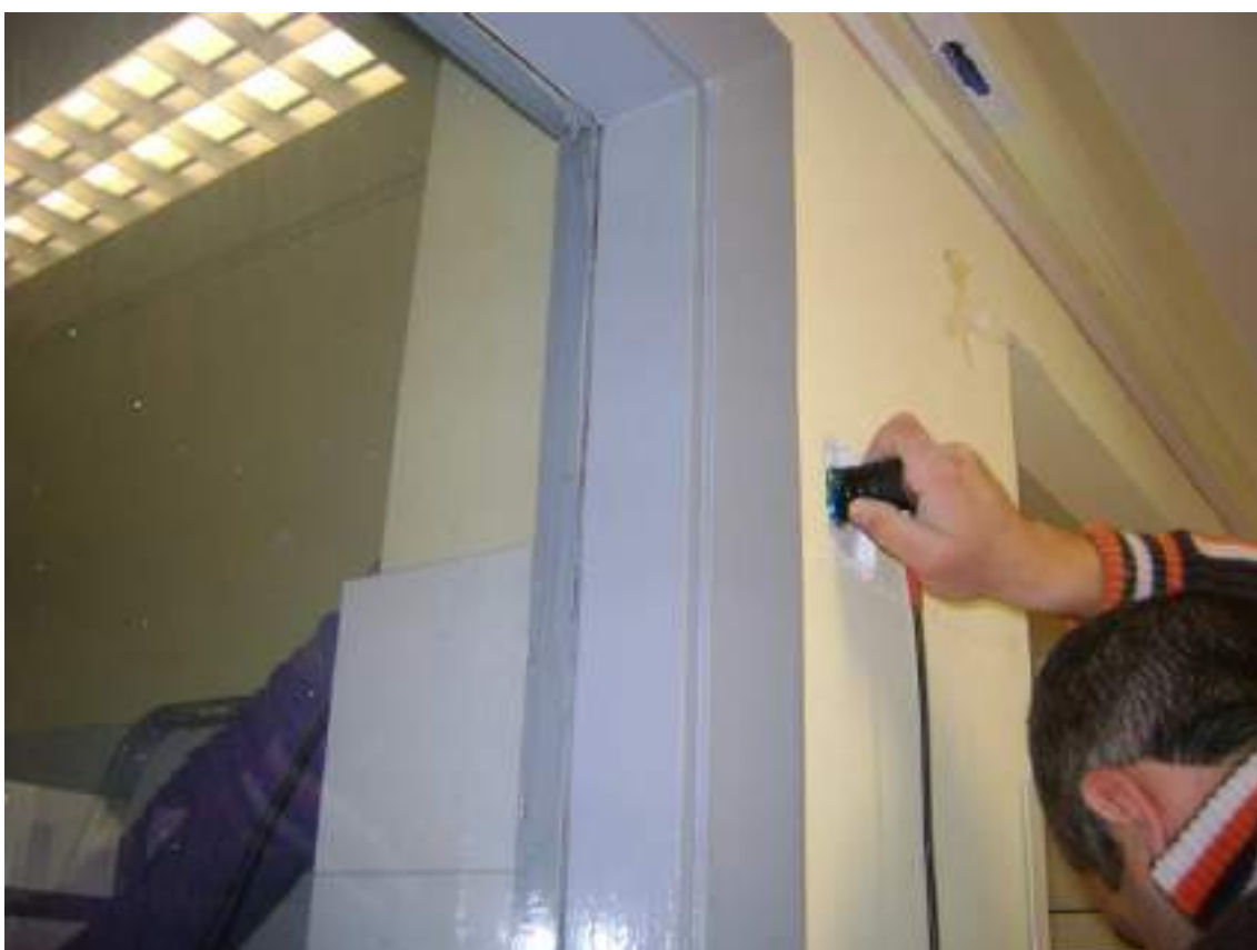
Figura 75 - Ultrasuoni pilastro P/1P/11
