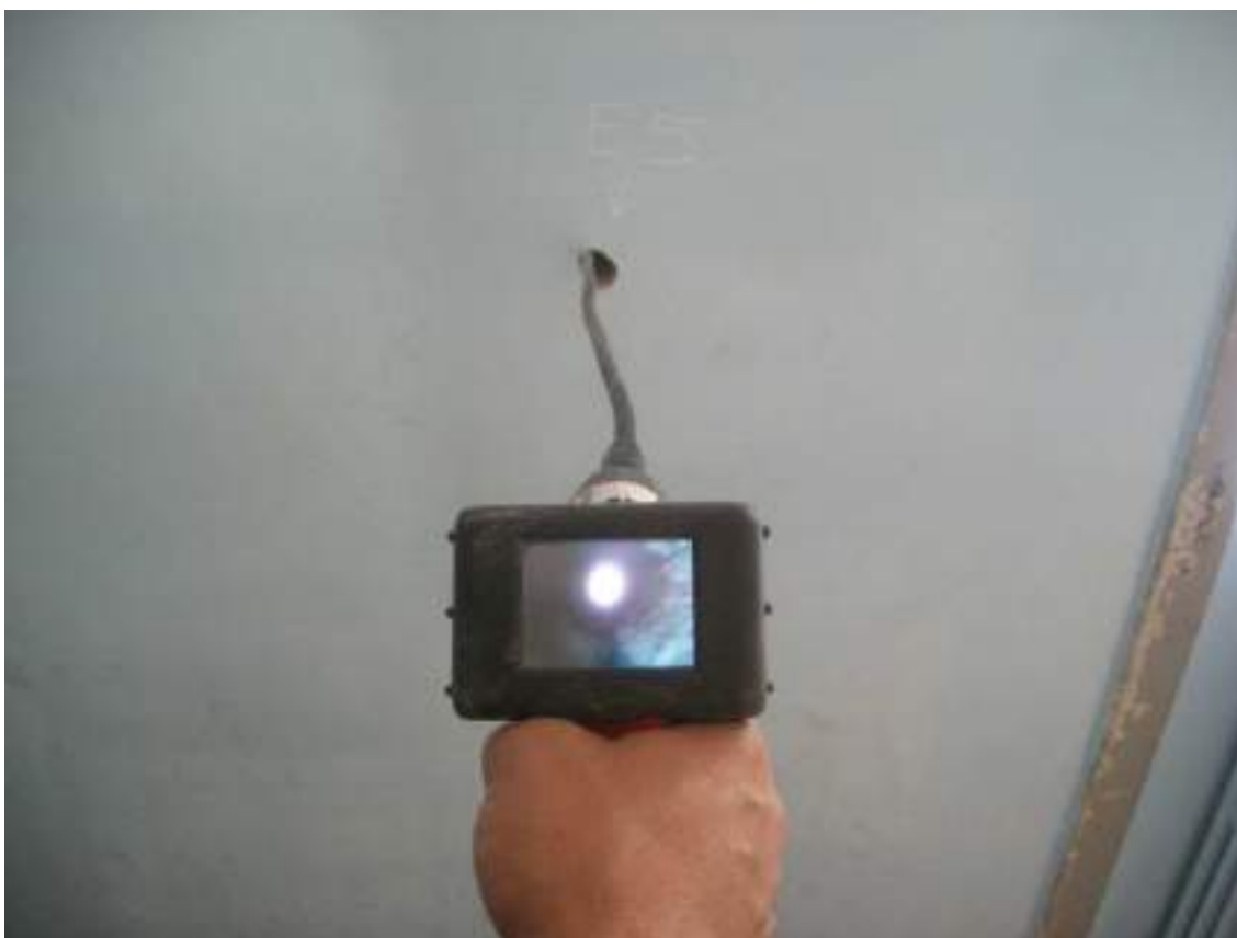
Figura 8 – Indagine endoscopica muratura (E5, Corpo B).
