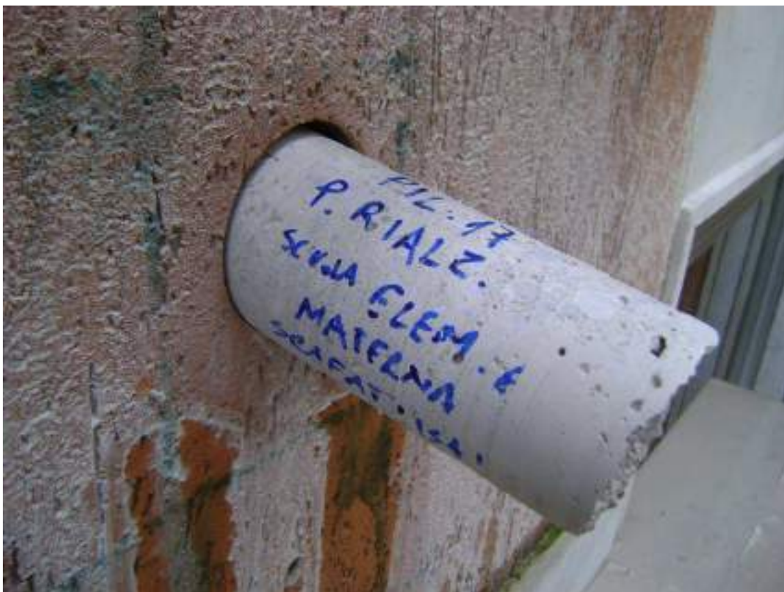
Figura 36 - Prelievo carota C4
