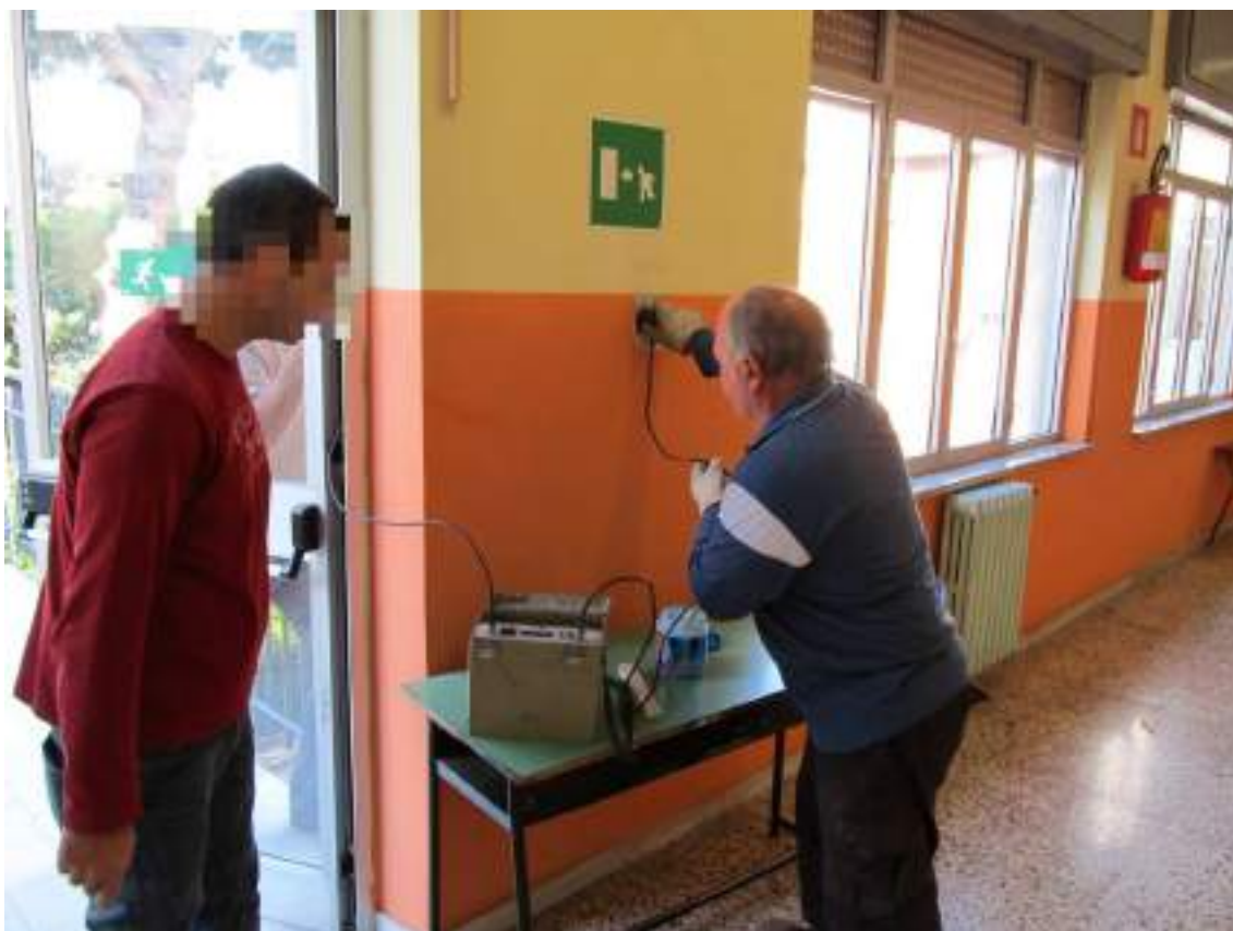
Figura 83 - Ultrasuoni pilastro P/1P/16
