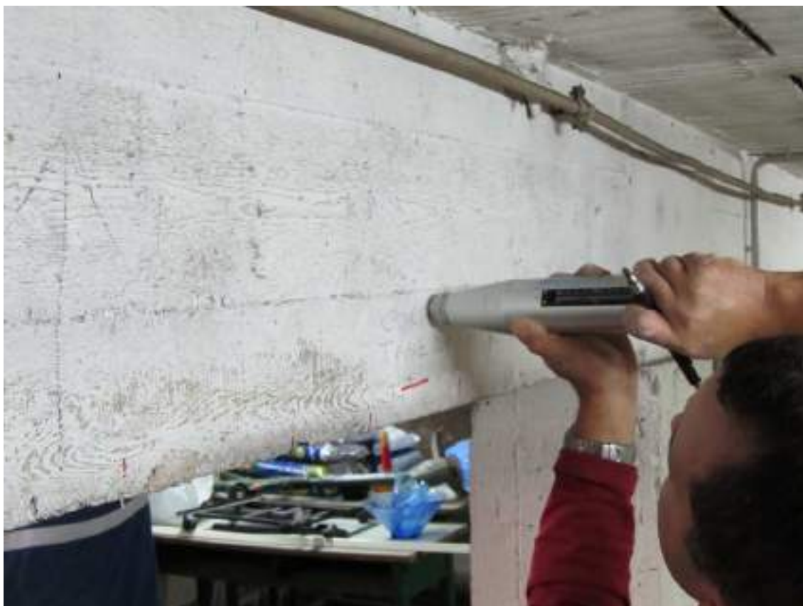
Figura 88 - Sclerometria trave dx Corpo B - PS
