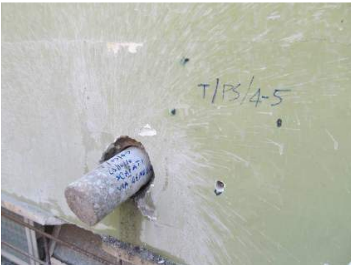
Figura 42 - Prelievo carota C9
