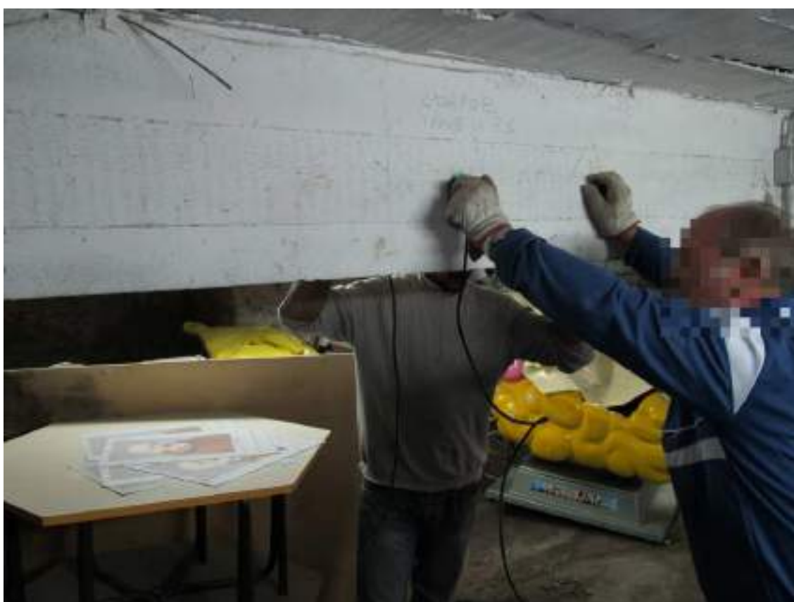
Figura 87 – Ultrasuoni trave sx Corpo B - PS
