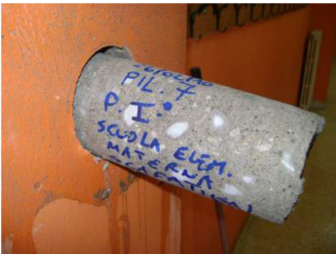
Figura 39 - Prelievo carota C6
