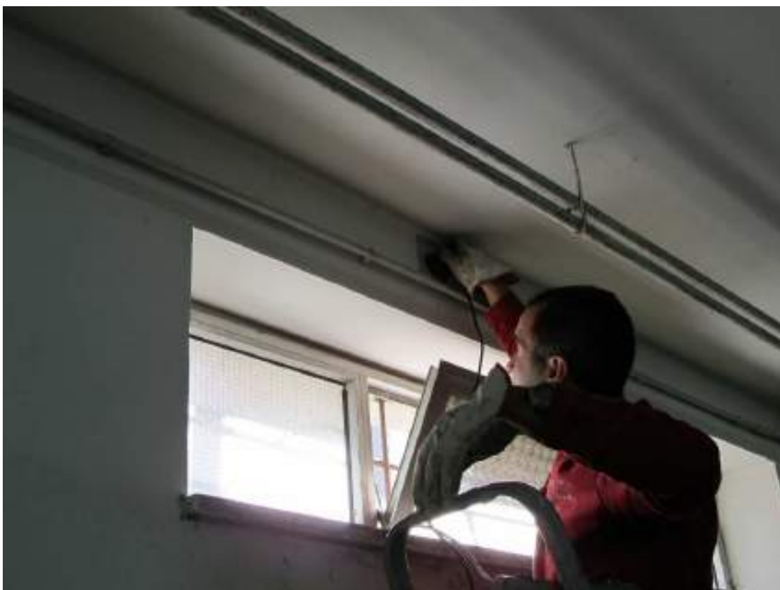
Figura 55 - Ultrasuoni trave T/PS/2-3
