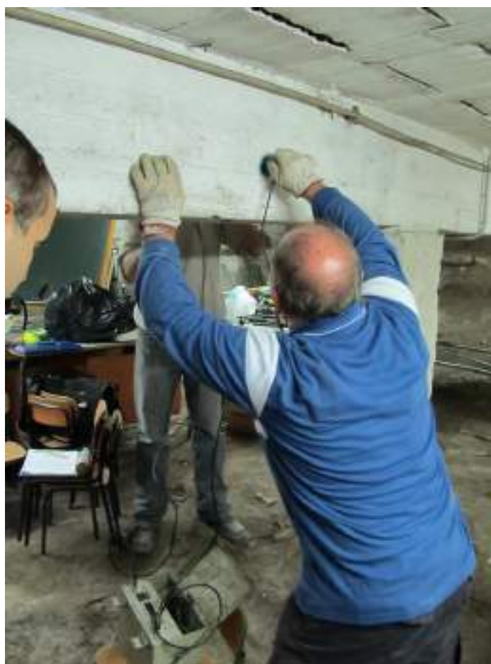
Figura 89 - Ultrasuoni trave dx Corpo B - PS
