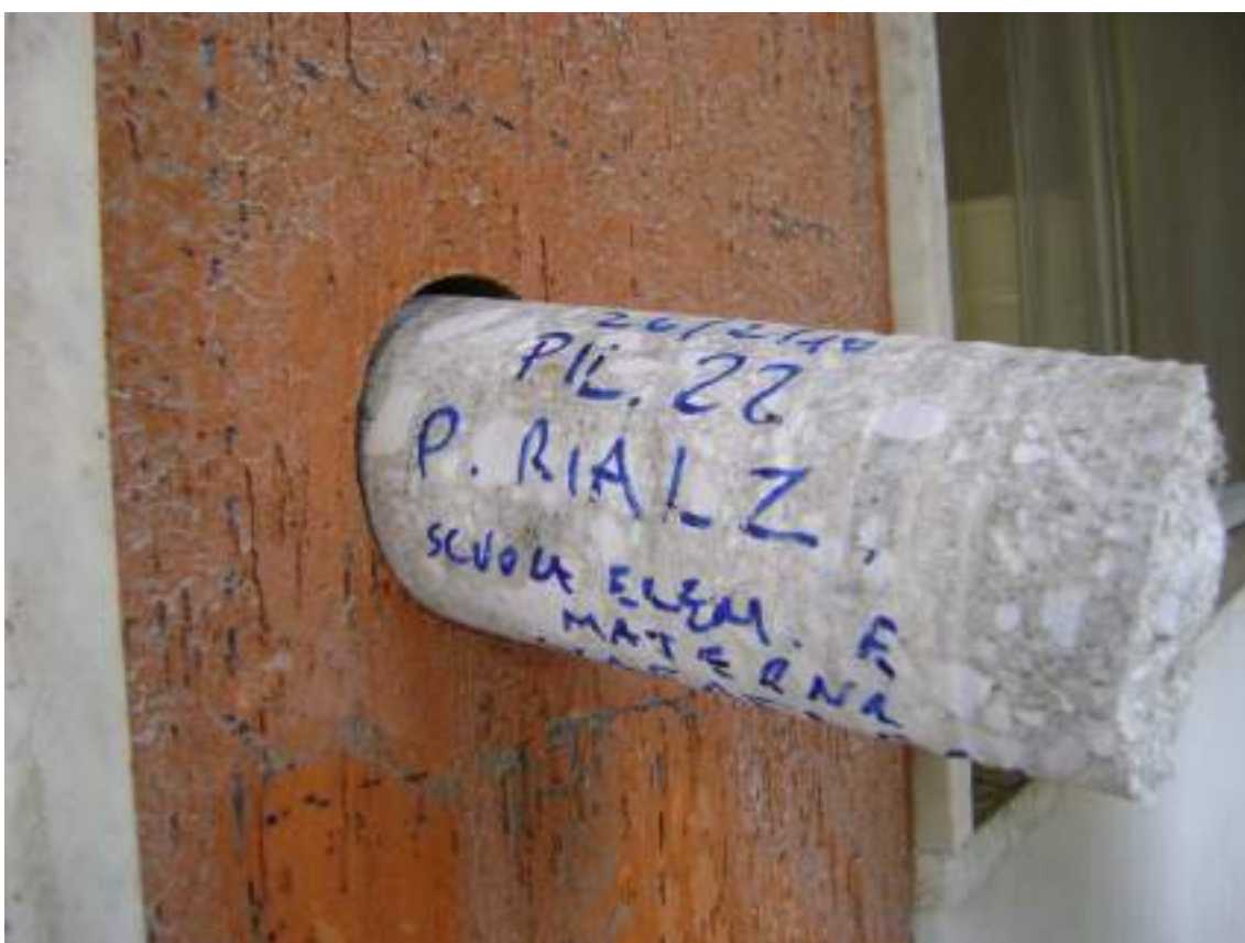
Figura 35 - Prelievo carota C3
