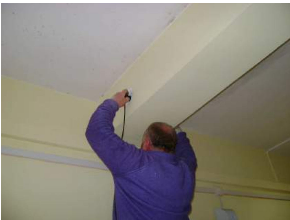
Figura 71 – Ultrasuoni trave T/1P/7-18
