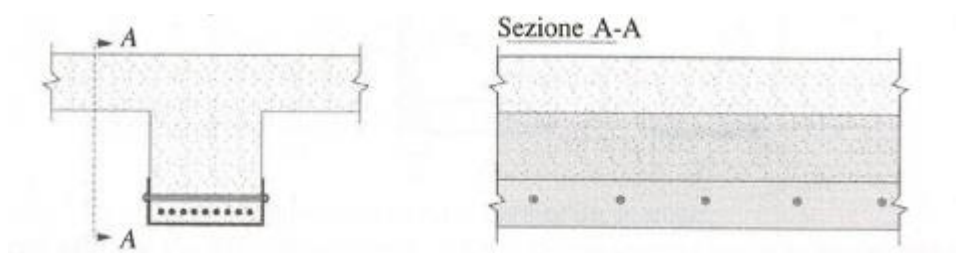
Figura 11: Esempio di placcaggio con lamina in acciaio
