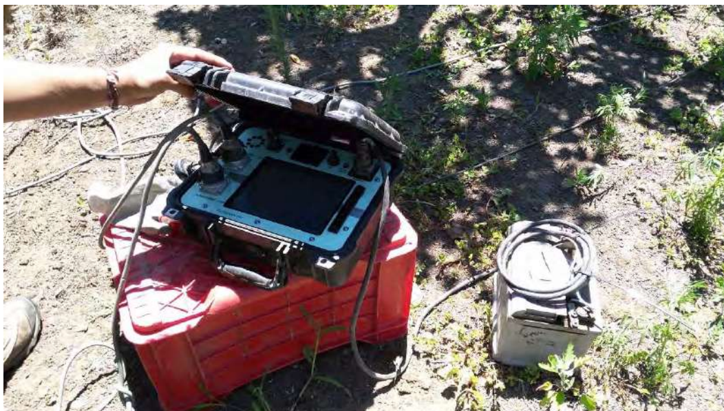
Indagine sismica di tipo Masw
