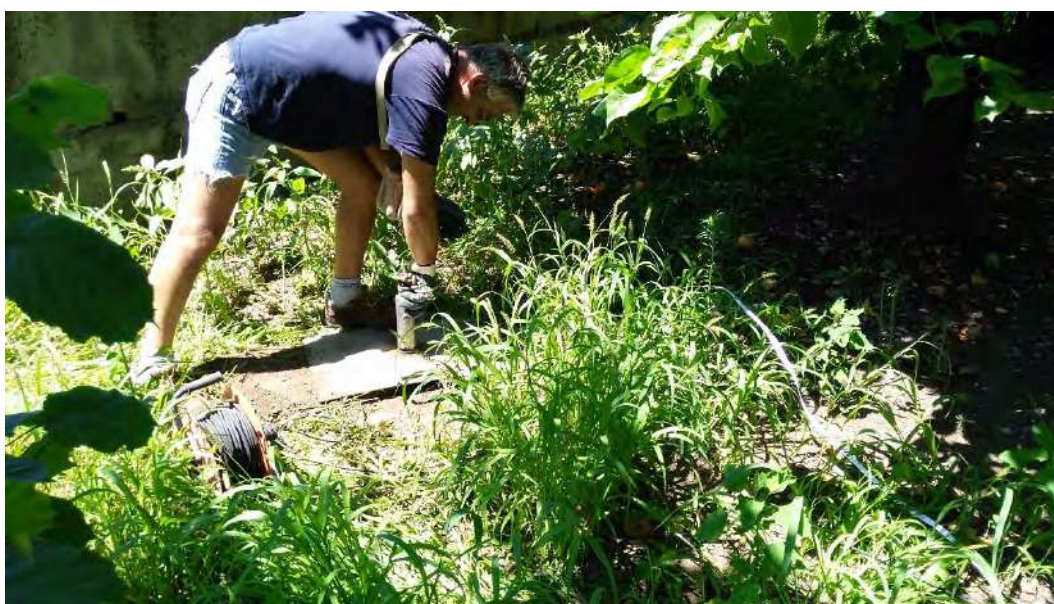
Indagine sismica Masw - fasi di energizzazione con fucile sismico
