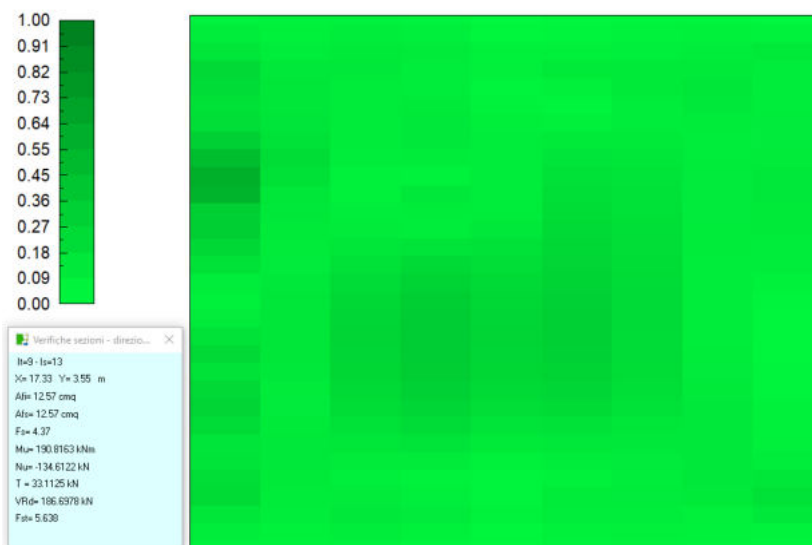
Figura 37 – Verifica a Flessione. Impegno armature in direzione y.
