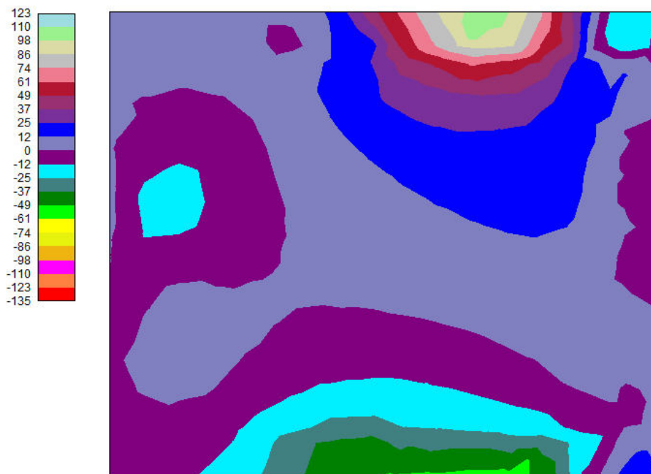
Figura 31 – Tensione normale N_x . Combinazione più gravosa (8).
