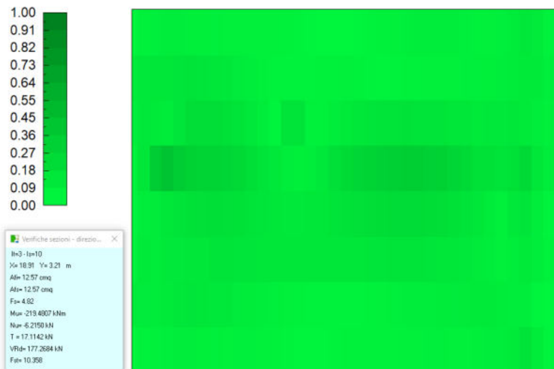
Figura 36 – Verifica a Flessione. Impegno armature in direzione x.
