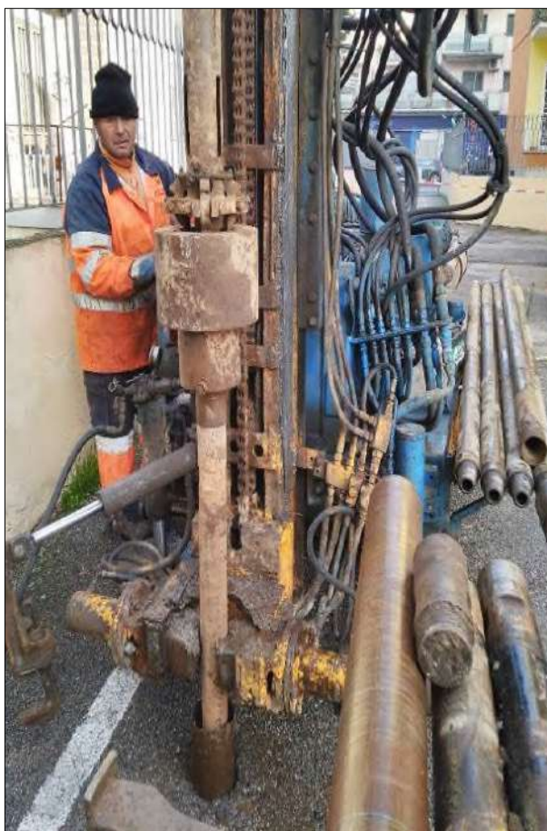
Esecuzione prova SPT
