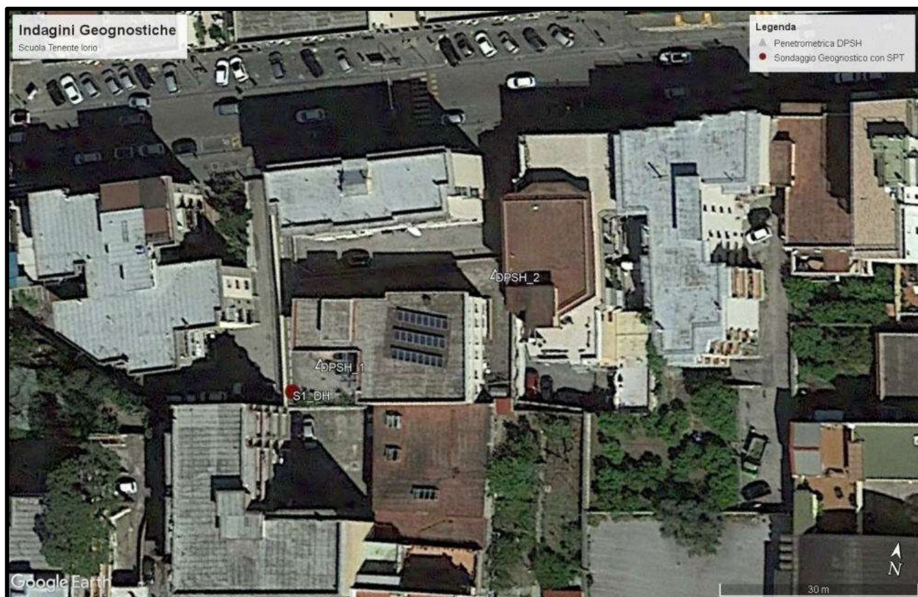
Fig. 6.1 - Ubicazione delle indagini geognostiche eseguite nell'area di studio (coordinate espresse nel sistema di riferimento WGS84/UTM 33N).
