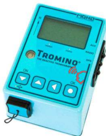
Figura 7.6 – Tromino utilizzato per effettuare le indagini di sismica passiva di tipo HVSR.
